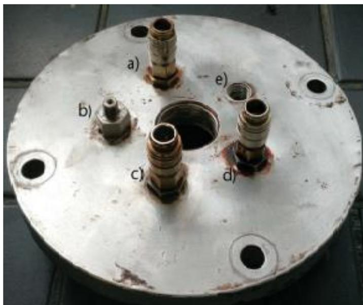
Legenda: a) Entrada de N<sub>2</sub>, b) Entrada do sensor de temperatura, c) Saída de gases, d) Entrada de sensor de pressão, e) Entrada de alimentação de solução.
